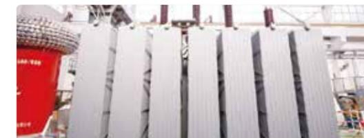
国内首台 110 千伏植物绝缘油变压器在广州研制成功，每台变压器每年可节约矿物油用量约 15-20 吨
